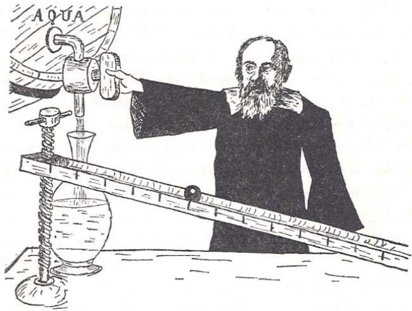
Abb. 2: Diese Zeichnung von Galileis legendären Experimenten zur Untersuchung der Fallbewegung visualisiert die entscheidenden Schritte zur Physik im heutigen Sinn: zum einen die Einführung des (raffiniert konzipierten) Experiments zur Überprüfung von Hypothesen, zum anderen die Festlegung von zweckmäßigen Einheiten, die Entwicklung einer Messtechnik und den Umgang mit Messfehlern; und schließlich den Ansatz, die Natur mit Hilfe der Mathematik und nicht nur verbal zu beschreiben. All dies stellte einen radikalen Bruch mit der aristotelischen Physik dar, die fast zwei Jahrtausende das Bewusstsein der Menschen geprägt hatte und offensichtlich für die Menschen bis dahin auch vollauf befriedigend war. (Quelle: [18])
